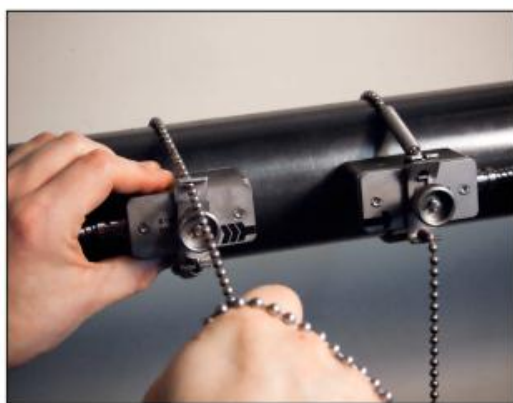
Крепление датчиков при помощи клипс и цепей
