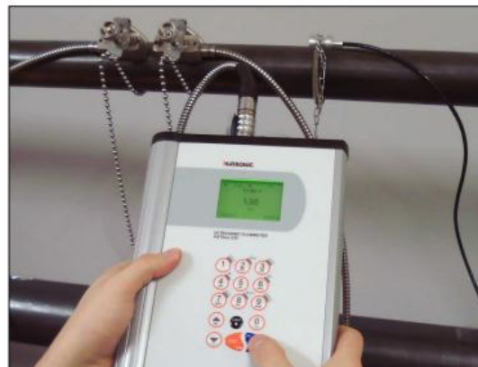
KATflow 230 в качестве теплосчетчика
