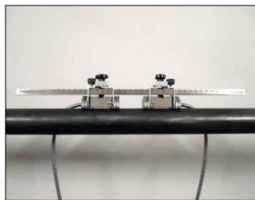
Крепление при помощи магнитной линейки
