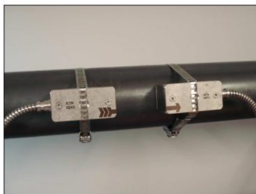
Крепление преобразователей при помощи лент и зажимов
